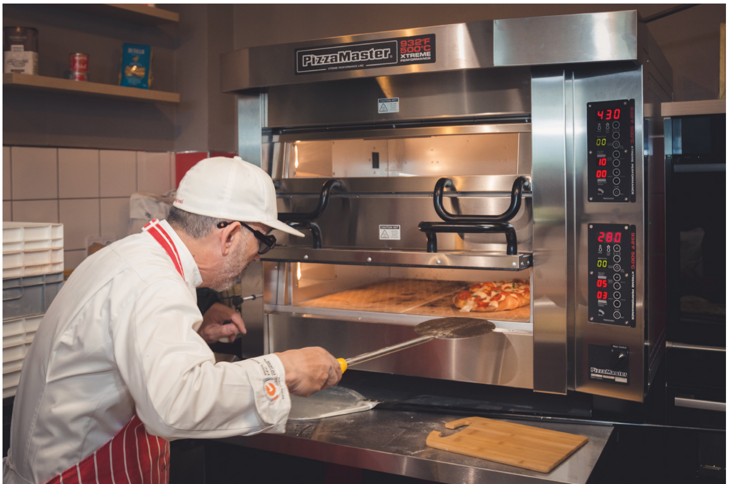
Cada cámara del horno se puede dividir fácilmente en dos pisos instalando una solera intermedia y un elemento, lo que duplica la capacidad del horno.
